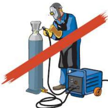
Ne pas utiliser la bouteille pour l'amorçage des électrodes de soudage
